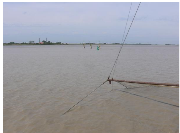
Afb. 3 Ankerkuilmeting op de Eems. Rechts is de bovenste boom zichtbaar van de uithangende ankerkuil. Op de achtergrond drie gele palen van een opstelling met staande kuilen van een beroepsvisser (Foto: Z. Jager).
